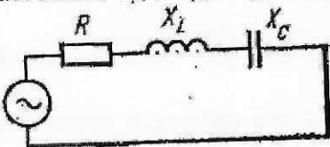
2. В сеть переменного тока частотой 50 Гц включены последовательно катушка с активным сопротивлением  $R = 30 \text{ Ом}$  и индуктивным  $X_L = 50 \text{ Ом}$  сопротивлениями и конденсатор с емкостью  $C = 318 \text{ мкФ}$ . Напряжение на конденсаторе  $U_c = 100 \text{ В}$ . Определить ток в цепи, напряжение на катушке и в сети, активную и реактивную мощности цепи. Построить векторную диаграмму.
