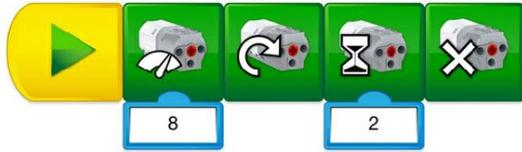
Эта программа запустит мотор на мощности 8, будет его прокручивать в одном направлении 2 секунды затем остановит.
